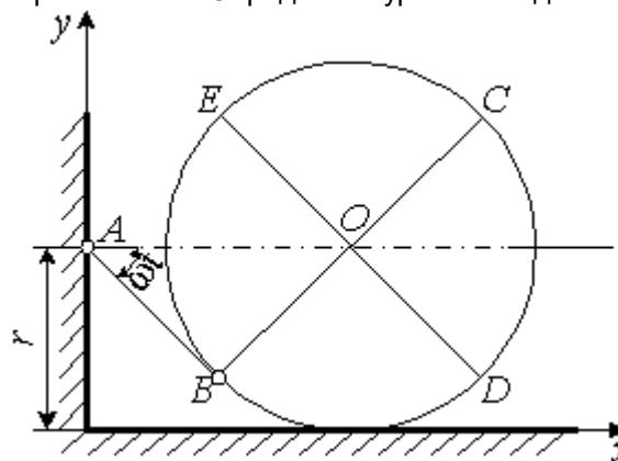
7. Стержень  $AB$  длиной  $l$  скользит концом  $B$  по вертикальной стене, а концом  $A$  – по полу, при этом  $V_A = V = \text{const}$ . Определить уравнения движения и уравнение траектории точки  $M$ , если при  $t = 0$  стержень вертикален. Вписать правильный ответ.
